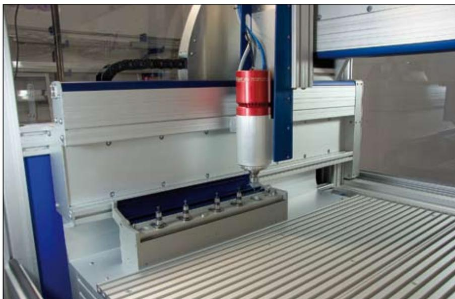
■ Frässpindel und Werkzeugstation an der Xpert 3D
