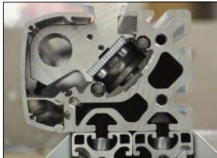
■ Querschnitt des neuen Profils
