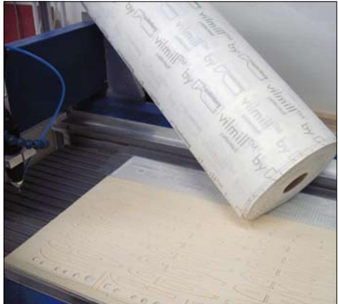
■ vilmill erhöht die Fixierung des Werkstückes.
