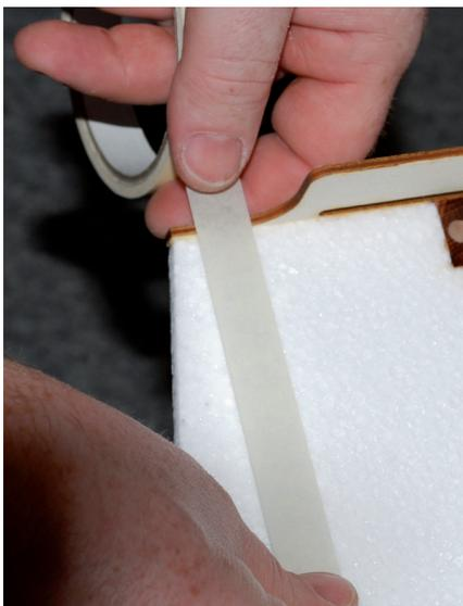
Verklebungen müssen bis zum vollständigen Aushärten mit Tape, Klammern oder ähnlichem fixiert werden
