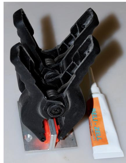
die Verklebung erfolgt großflächig. Wiederum müssen die Bauteile fixiert werden!
