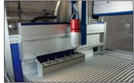
■ Spindel mit Werkzeugwechsler
