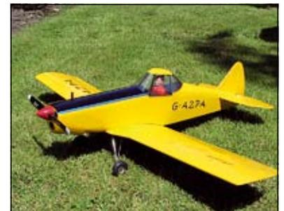
Hier sehen Sie das neueste Modell von MS Designs: Mike Banks' Piper Pawnee. Jedes Teil wurde auf einer Basic 540 gefertigt. Bei einer Spannweite von 54 inch (ca. 1,37 m) wiegt der Flieger nur etwas mehr als 4 lb (ca. 1,8 kg).
