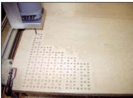
■ Die Nuttschicht der Vakuumpalte.
