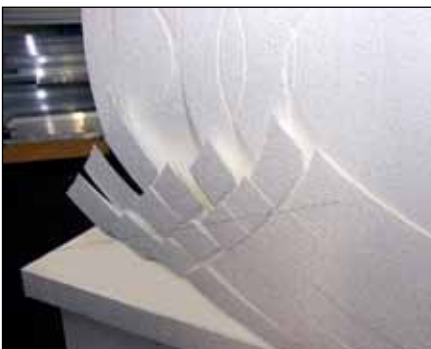
■ Die Kugel wird dabei durch schrittweises Drehen bei wiederholtem Schneiden hergestellt.
