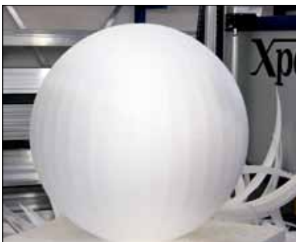
■ Testschnitt einer Kugel auf der Xpert CUT 2500.
